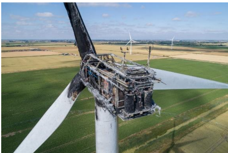
5.2.6. attēls. VES bojājumi, ko izraisījis ugunsgrēks 221
