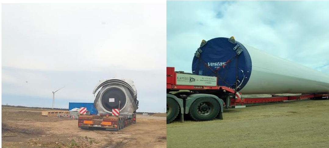
4.3.14. attēls. VES detaļu transportēšana Latvijā: Tārgales projekts, 2022 (foto: Enviroprojekts)
