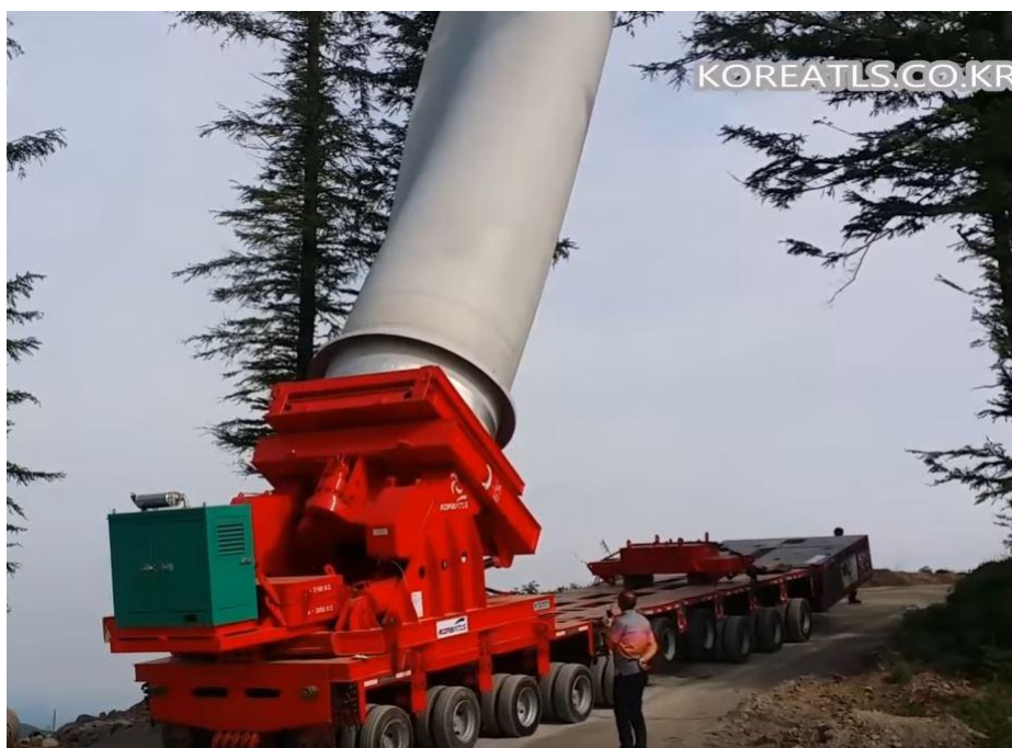
4.3.13. attēls. Speciālā tehnika VES spārnu transportēšanai
