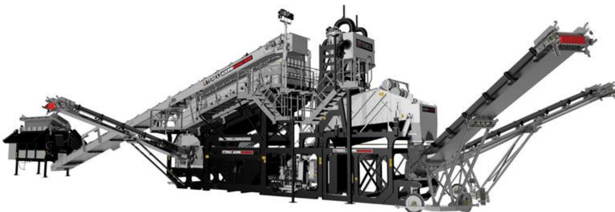
1.9. attēls. Smilts-grants sijātāja/mazgātāja ilustratīvs paraugs: TEREX Aggresand 165 4 .
