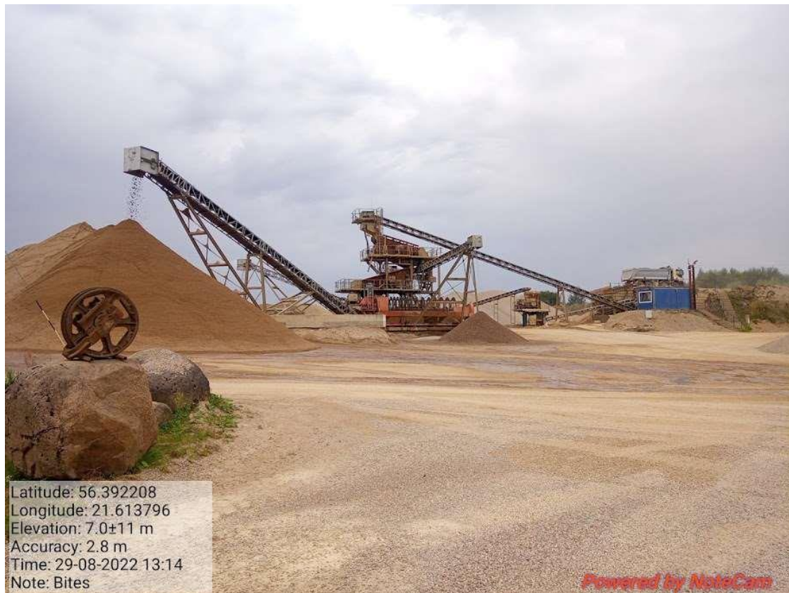
1.5 attēls. Materiāla pārstrādes iekārta ar elektropiedziņu "Bitēs".
