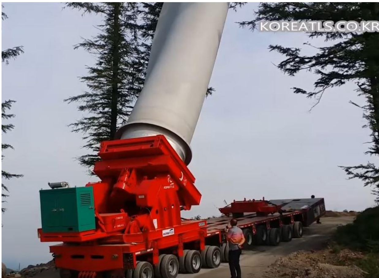
1.7. attēls. Speciālā tehnika VES spārnu transportēšanai.
