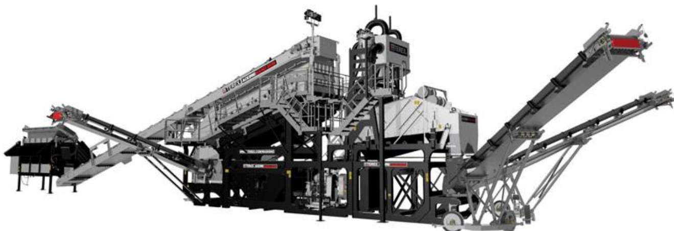
2.8. attēls. Smilts sijātāja/mazgātāja ilustratīvs paraugs: TEREX Aggresand 165 3 .
